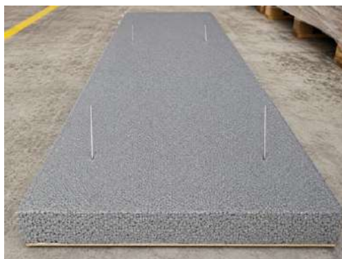
Agrafe dépliée avant coulage béton
