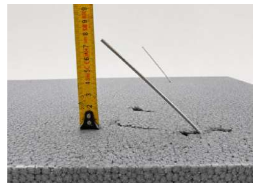
Ancrage de 5 cm mini dans la dalle
