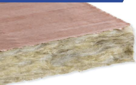
Panneaux semi-rigides ( $40 \text{ kg/m}^3$ ) d'épaisseur constante, constitués de fibres de laine de roche, revêtus d'un kraft.
