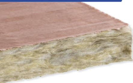
Panneaux semi-rigides (30 kg/m<sup>3</sup>) d'épaisseur constante, constitués de fibres de laine de roche, revêtus d'un kraft.
