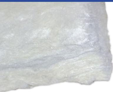
Rouleaux en laine de roche en vrac enroulés, constitués de fibres à faible contenu de liant.
